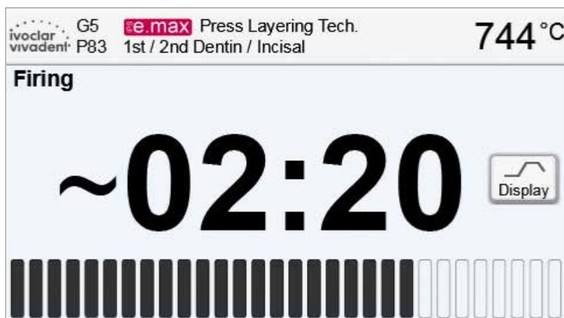
Заводские настройки печи таковы, что кривая обжига автоматически отображается при старте программы.
