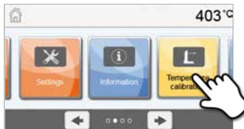
С помощью кнопок со стрелками можно переходить на следующие страницы домашнего экрана, где расположены остальные функции.
